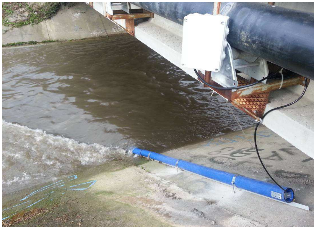
Figura 29 – Installazione della sonda S/N 13M101704 all'interno del CSNO
